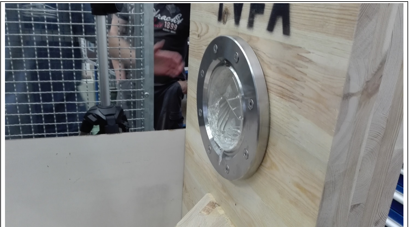
Abbildung 8: Versagensbild 2 - Lastaufbringung auf liegenden Glassäule
