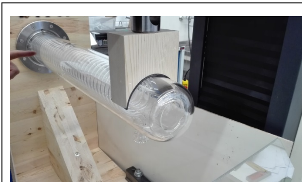
Abbildung 4: Detail für vertikale Lasteinleitung
